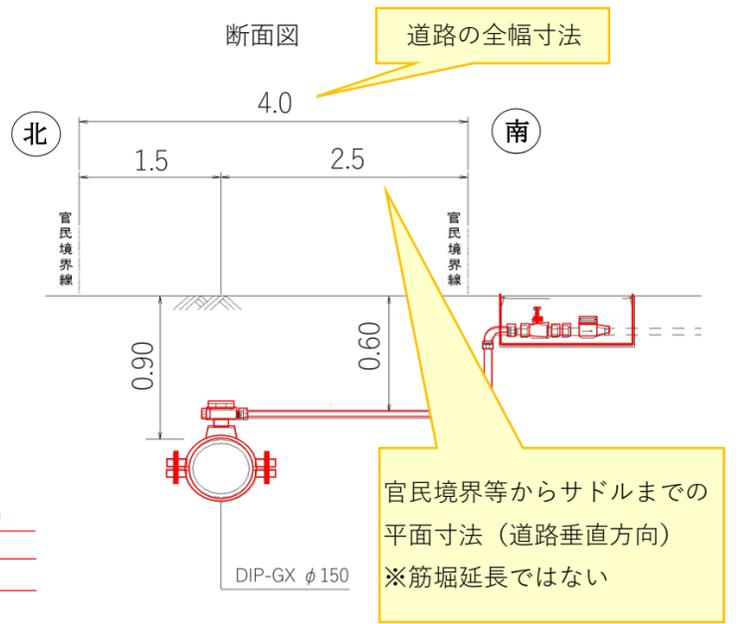
施工した給水管、止水栓等の給水装置材料の記入
