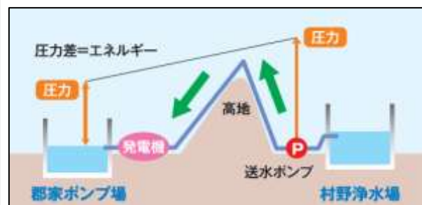
図 6 - 2 受水圧発電設備
