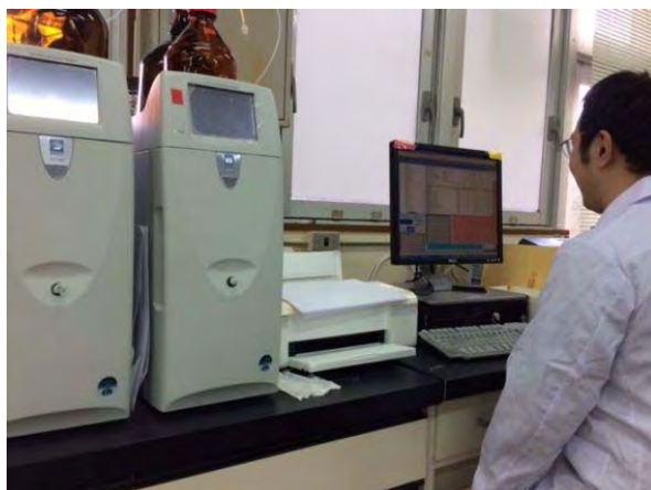
図-4.1.5 イオンクロマトグラフ 分析状況 (河南水質管理ステーション)
