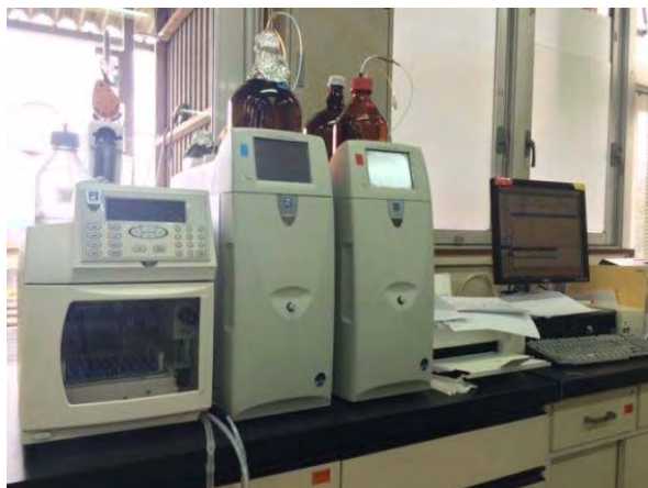
図-4.1.3 イオンクロマトグラフ 分析機器 (河南水質管理ステーション)
