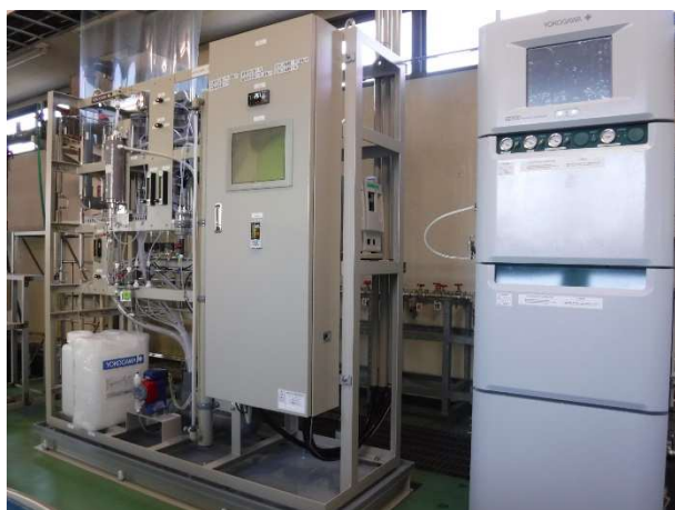
◇ゆうきセンサー （ガスクロマトグラフ計による 揮発性有機化学物質の監視）
