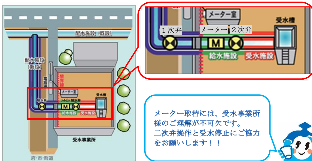
工業用水道メーター設置概要図
