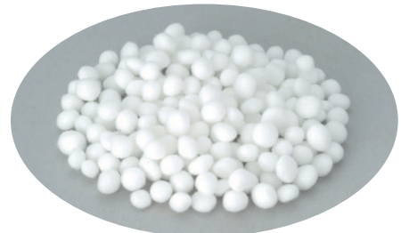
繊維担体(材料:ポリエステル、形状:5mmから7mmの球状)
