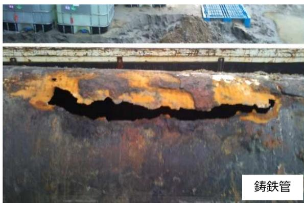
老朽化により破損した水道管
