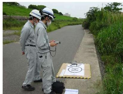
庭窪浄水場では、沖出し取水口の状況を迅速に確認するため、ドローンを導入しました。これまではITVカメラやゴムボート等を用いて確認を行っていましたが、ドローンを使用することで、取水口付近の状況をより詳細に確認できるようになりました。
