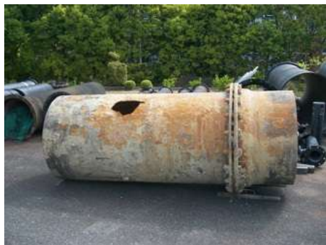
老朽化した铸铁管
