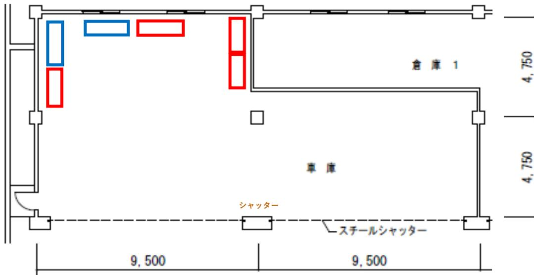
※転倒防止金具及び取付：1式(アンカーボルトで4か所/台固定)。床面はコンクリート。
