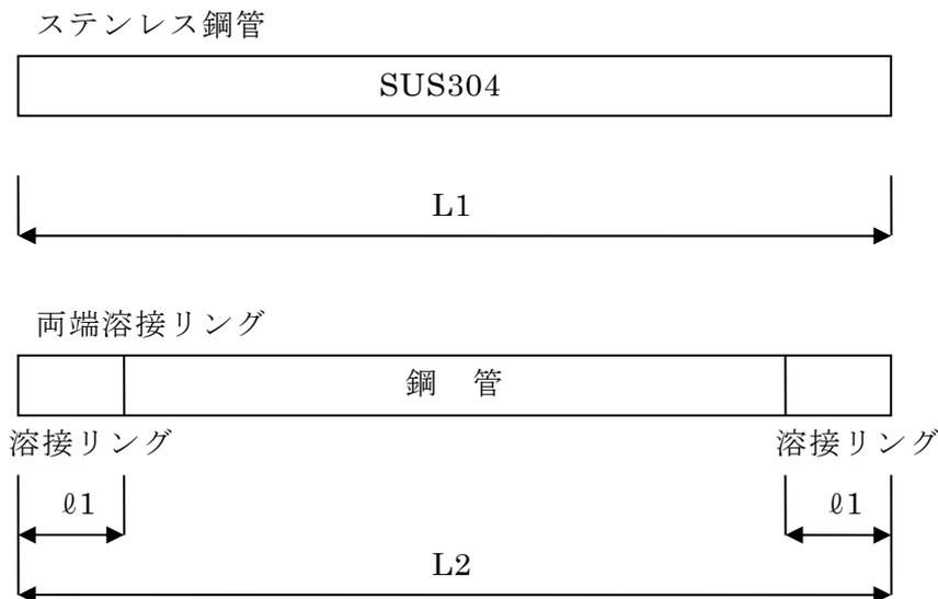
②ステンレス鋼管の重量算出式（SUS304）
